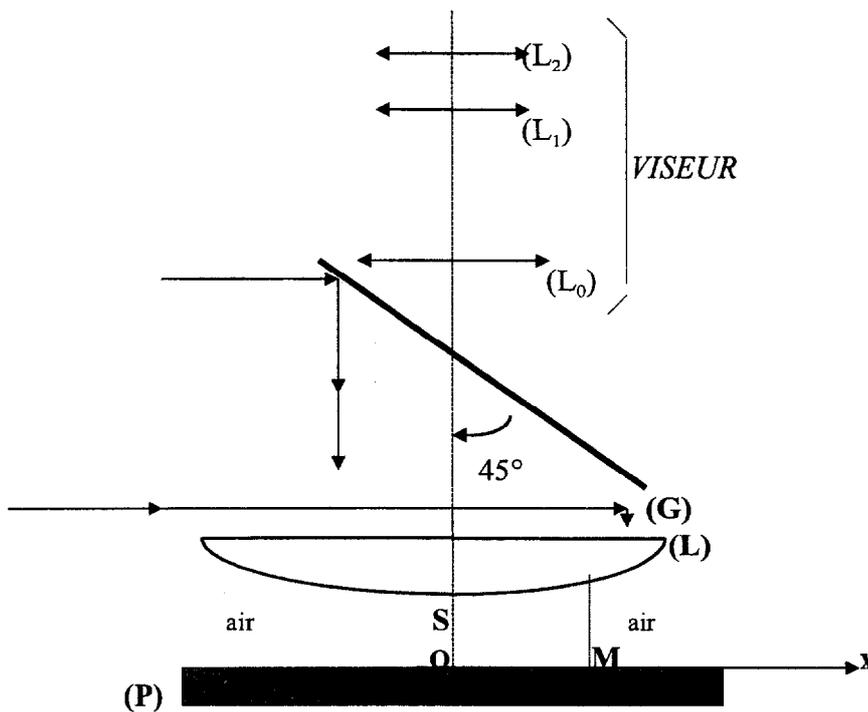
(G) : lame semi-réfléchissante inclinée à  $45^\circ$  par rapport à l'axe du viseur.
